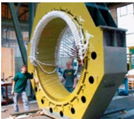
Neuwicklung Holzschleifermotor 4600 kW, 250 min -1
